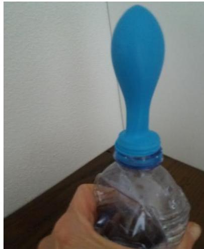
SE LA BOTTIGLIETTA FOSSE TAPPATA, PREMENDO SULLE PARETI IL VOLUME DELL'ARIA diminuirebbe leggermente, indicando che l'aria sente una pressione da parte dell'acqua, esercitata a sua volta dalla pressione fatta sulle pareti della bottiglietta.
