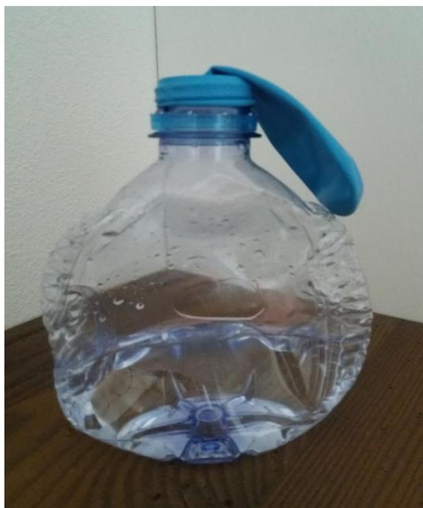
Quando si comprime la bottiglietta, premendo sulle pareti, la pressione si trasmette all'acqua (che
